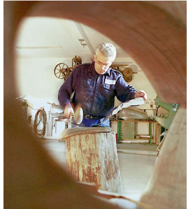
Nach dem Einscannen des Klee-Modells entsteht aus einzelnen Holzfrästeilen das Klopffmodell für die Karosseriearbeiten. Rechts Beginn der ca. 400 Stunden dauernden Blecharbeiten.
