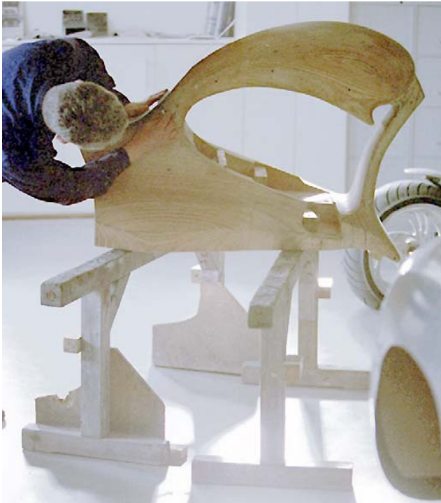
Nach dem Einscannen des Klee-Modells entsteht aus einzelnen Holzfrästeilen das Klopffmodell für die Karosseriearbeiten. Rechts Beginn der ca. 400 Stunden dauernden Blecharbeiten.
