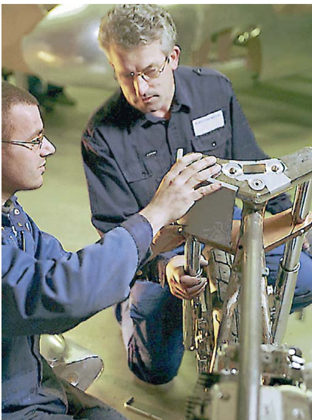
Anpassen der Lampenverkleidung an die Gabelbrücken.
